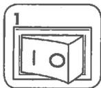
1 Zapojte skartovačku a přepněte hlavní vypínač do polohy ZAPNUTO (I)
