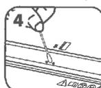
4 S použitím vatičky setřete nános nečistoty ze senzoru pro zjišťování papíru
